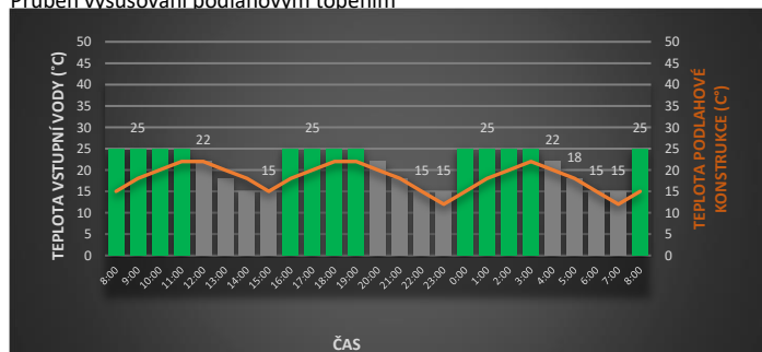
Průběh vysušování podlahovým topením
